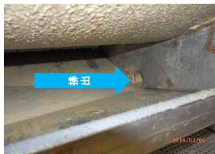
パンチング穴1.5mmから分解液が排出されます。一部攪拌ヘラで押し出される汚泥も排出されます。(粉物などは分解される前に排出される)
